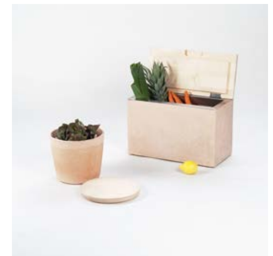
Der Topf-in-Topf Kühlschrank basiert auf dem Prinzip der Verdunstungskühlung. In dem äußeren Tongefäß befindet sich ein Edelstahlbehälter, der Zwischenraum ist mit feuchtem Sand befüllt. Durch die Verdunstung des Wassers nimmt die Temperatur im Innenraum stetig ab und hält so die innen gelagerten Lebensmittel frisch.
