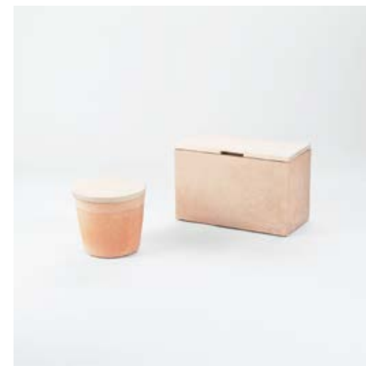
Der Topf-in-Topf Kühlschrank basiert auf dem Prinzip der Verdunstungskühlung. In dem äußeren Tongefäß befindet sich ein Edelstahlbehälter, der Zwischenraum ist mit feuchtem Sand befüllt. Durch die Verdunstung des Wassers nimmt die Temperatur im Innenraum stetig ab und hält so die innen gelagerten Lebensmittel frisch.
